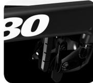
**Frein arrière positionné sous le boîtier de pédalier**
