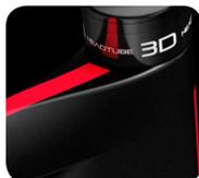
**Direction 3D: 3 longueurs de tube de direction intégrées dans toutes les tailles du cadre pour régler la hauteur du guidon**
