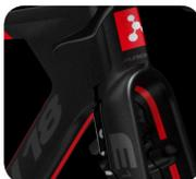
**E118 monocoque carbone fourche** avec colonne de direction aérodynamique externe et assise de jeu de direction intégrée
