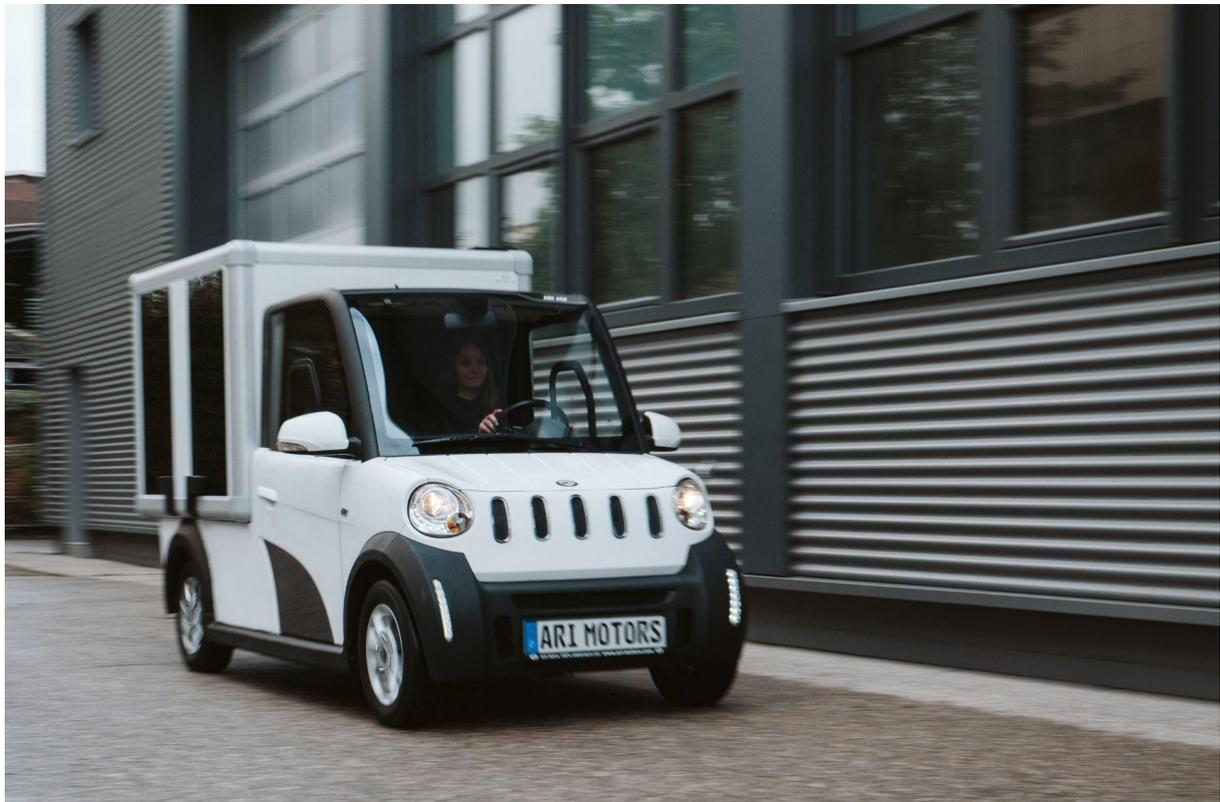
*01 - ARI 458 Kofferaufbau L mit integriertem Solarmodul*
