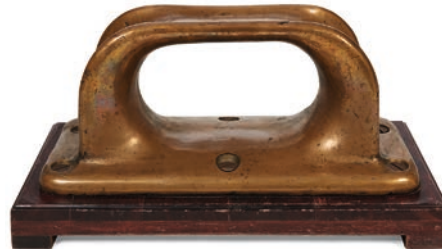
• 106 • CHAUMARD FERME Importante pièce d'accastillage en bronze présumée provenir d'un paquebot, servant à guider les aussières pour éviter le ragage, montée sur un socle en bois Haut. : 33 cm. (13 in.), Long. : 66 cm. (26 in.), Prof. : 31 cm. (12 ¼ in.) Bronze bridge accessory,probably from a liner 500 – 800 €
