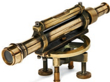
• 114 • HORIZON ARTIFICIEL En bronze et laiton, avec lunette de visée surmontée de son niveau de positionnement, posée sur ses trois vis de réglage, marqué : « GB, HBQ » Haut. : 12,5 cm. (5 in.), Long. 24,5 cm. (10 ¾ in.) A bronze and brass artificial horizon 200 – 300 €
