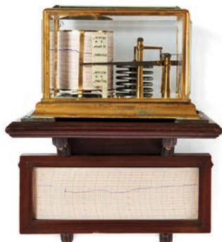
• 92 • BAROGRAPHE ENREGISTREUR Par Richard Frères, vers 1885 Baromètre enregistreur à 5 capsules contenu dans une boîte en bronze doré, laiton et verre, sur son support en acajou ouvrant par un rabat vitré permettant d'afficher les pressions de la semaine précédente. Porte le N° 40804 et la signature Richard Frères utilisée de 1882 à 1890 inclus. Bien complet de ses feuilles et de son stylet ainsi que d'une bouteille d'encre. Haut. : 13 cm. (5 in.), Larg. : 20 cm. (7 ¾ in.), Prof. : 13 cm. (5 in.) Bronze, brass and glass case barometer, by Richard Frères, circa 1885 600 – 1 000 €
