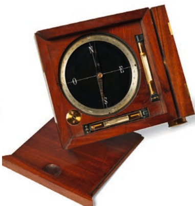
• 87 • BOUSSOLE DE RELÈVEMENT DITE FORESTIÈRE Boîtier en acajou à couvercle à glissière, platine carrée à nivelle, boussole divisée sur fond noir, lunette latérale et pied orientable en laiton ; manque le verre protecteur Haut. fermée : 10 cm. (4 in.), Prof. : 20,5 cm. (8 in.), Larg. : 22 cm. (8 ¾ in.) Diam. du compas : 13,5 cm. (5 ½ in.) Mabogany recording compass ; the glass missing 300 – 500 €
