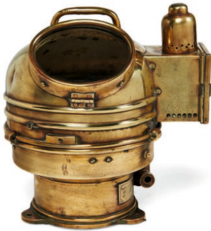
• 109 • COMPAS DE ROUTE Fin du XIX e siècle En laiton, contenu dans son habitacle à vérine pour l'éclairage de nuit, sans compensateur, destiné à un yacht ou un navire en bois, rose dite liquide, cuve hémisphérique montée à la cardan Haut. : 27 cm. (10 ½ in.), Larg. : 26 cm. (10 ¼ in.), Diam. : 20 cm. (8 in.) Brass road compass, late 19 th century 700 – 1 000 €
