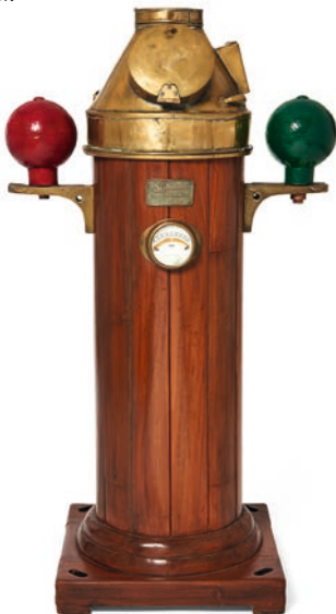
• 120 • COMPAS MAGNÉTIQUE ET SON HABITACLE Sestrelina, Fabrication Anglaise Habitacle en laiton, le fût en acajou, avec fenêtre de consultation fermant par couvercle et vérine d'éclairage latérale (absente), niveau indicateur de gîte sur le fût, boules sur potences latérales, signé Henry Browne & Son, London, type 90440, compas liquide signé AFT, type n° 90324 Haut. : 140 cm. (55¼ in.), Base : 53 x 53 cm. (21 x 21 in.) A British brass magnetic compass and its mahogany base 1 800 – 2 500 €
