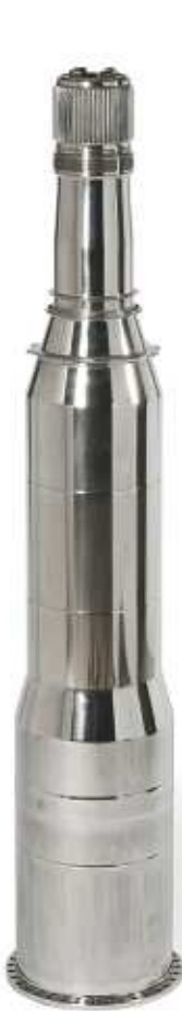
• 155 • CONCORDE Axe de compresseur du réacteur de l'olympus, circa 1987 en chrome-molybdène vanadium et base en fer. 6 000 / 8 000 €
