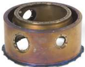
• 188 • CONCORDE Carter réacteur olympus En titane. Neuf marques de maintenances gravées sur la pièce. Diam. : 45 cm 2 500 / 3 000 €
