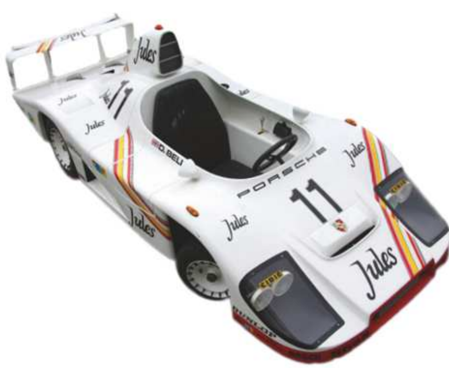
• 161 • PORSCHE 936 JUNIOR Fabrication par l'usine Porsche Voiture d'enfant, réplique à l'échelle ½ de la Porsche 936/78 turbo victorieuse de Jacky Ickx aux 24 Heures du Mans de 1976 et 1977, carrosserie en fibre de verre, à châssis tubulaire de section carrée, moteur Briggs et Stratton de 200 cm³ et 5 cv, démarreur électrique, 2 vitesses et marche arrière, frein à disque arrière type karting, suspension avant et arrière, phares, codes et clignotants. Ce modèle fut distribué par Porsche dans les années 1980 pour quelques privilégiés. Edition limitée entre 50 et 100 exemplaires. L'arme absolue pour participer au prochain «Little big Mans». Vitesse maximum : 51 km/h. Poids: 158 kg. Haut. : 90 cm. (35 ¼ in.), Long. : 273 cm. (107 ½ in.), Larg. : 100 cm. (39 ½ in.) Motor child car, 1/2 scale, Porsche 936/78 Jacky Ickx at Le Mans, fiberglass body, tubular chassis, Was distributed in 1980 by Porsche for the privileged few, estimated between 50 and 100 numbers made. Fitted with a Briggs and Stratton 200cm³ and 5hp. Two forward gears and one reverse gear, rear disc brake, suspension and very complete electrical circuit with the starter, lights and flashing indicators. The absolute weapon to enter next «Little big Mans». Maximum speed: 51 km/h. Weight: 158 kg 18 000 / 22 000 €
