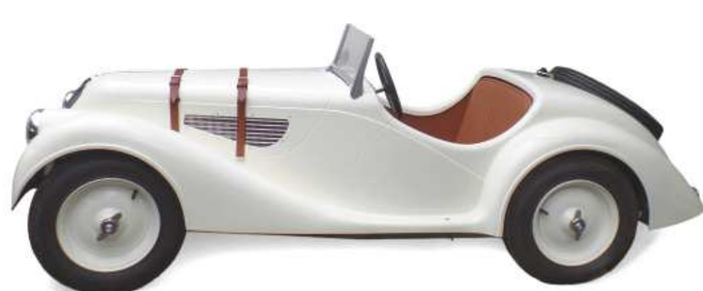
• 157 • BMW 328 COLLECTOR CAR Fabriquée par Bérard à Brignais en France, #0034, en mars 2008 Voiture pour enfant à l'échelle 1/10ème, équipée d'un moteur thermique Robin Subaru 169 cm3, 4 temps, démarreur électrique, embrayage automatique, freins à tambours, phares et feux lumineux, châssis tubulaire, carrosserie en matériaux composites. Eligible au Little Big Mans Haut. : 67 cm. (26 ¼ in.), Long. 212 cm. (83 ½ in.), Larg. : 98 cm. (38 ½ in.) Motor child car made by Bérard (Brignais in France), #0034, in March 2008, 1/10th scale, fitted with a Robin-Subaru 169 cm3 gasoline engine, electric starter, automatic clutch, drum brakes, functional headlamps and lights, tubular chassis, composite bodywork. Eligible for Little Big Mans 6 000 / 10 000 €
