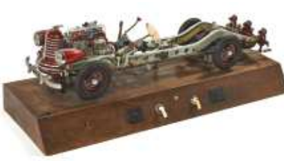
• 155 • HOHM MODELS Grande maquette d'apprentissage pour auto-école, fabrication allemande Grande maquette d'apprentissage pour auto-école, fabrication allemande Maquette écorché d'automobile, structure métallique laissant apparaitre les différents éléments mécaniques et leur fonctionnement, système électrique, monté sur un socle en bois avec panneau de commande, premier modèle de la marque Long. : 107 cm. (42 in.) A large-scale instructional model car, by Hohm models 700 / 1 000 €
