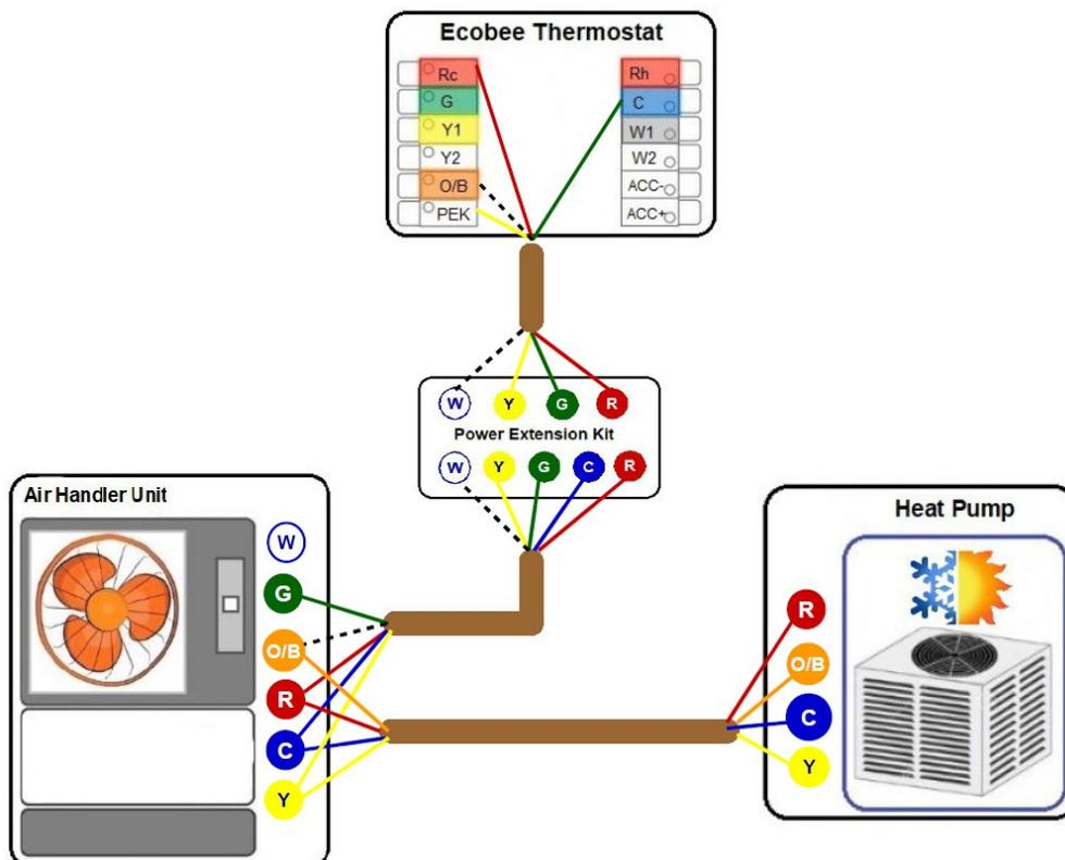
Diagram 11. Heatpump (2-stage)
