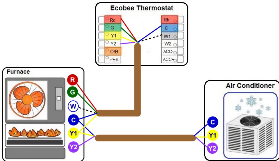
Diagram 9. Heatpump (1-stage)
