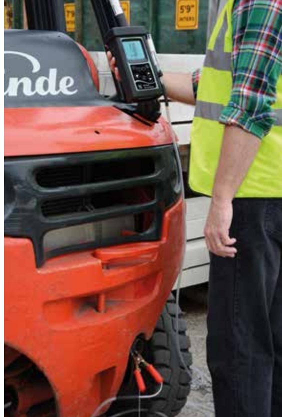
Mesure des émissions d'échappement des chariots élévateurs
