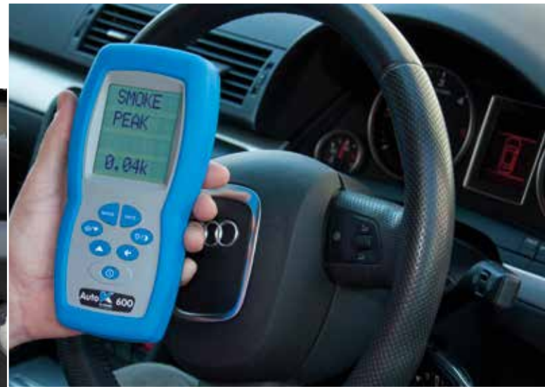
Mesure de gaz d'échappement de moteur diesel pour voitures et véhicules utilitaires
