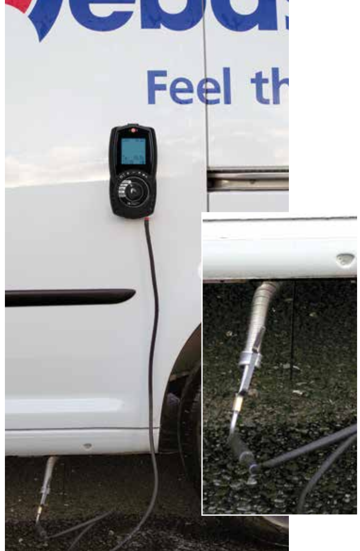
Mesure du CO 2 d'un chauffage auxiliaire
