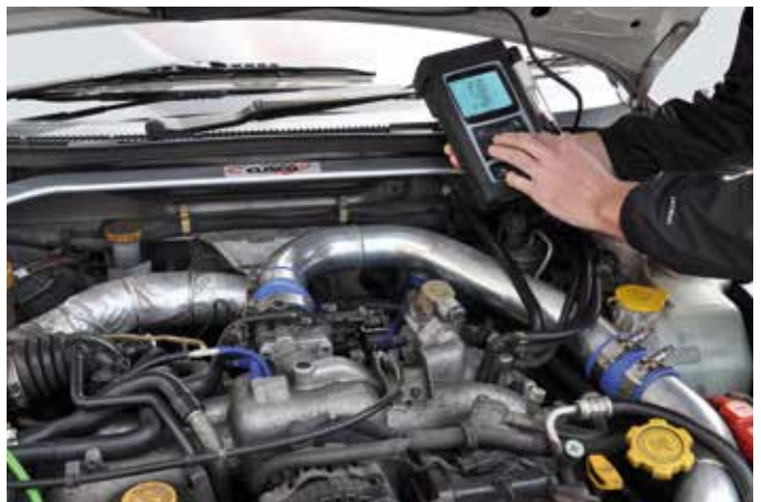
Analyse des gaz d'échappement et diagnostic moteur
