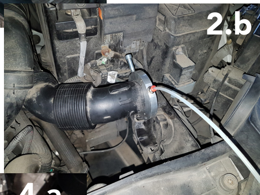
Tête de pulvérisation fixé sur l'entrée la durite de filtre à air
