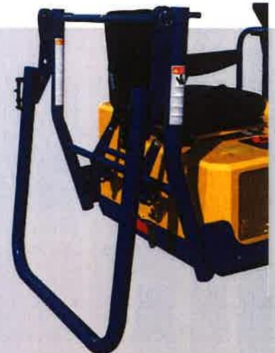
• **ARCEAU DE SECURITE REPLIABLE - ROPS**
