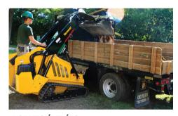
NORMES ÉLEVÉES. Le CTX100 est livrée de série avec un système hydraulique double capable d'assurer 15,5 gpm (58,7 L/min) de débit hydraulique pour alimenter les accessoires les plus exigeants, mais aussi un débit minime de 8,1 gpm (30,7 L/min) pour maximiser la maîtrise.
