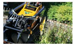
PRODUCTIVITÉ. Capacité de basculement maximum de 2958 lb (1341,7 kg) et capacité de service nominale de 1035 lb (469,5 kg) pour un levage efficace face à des conditions du sol difficiles.
