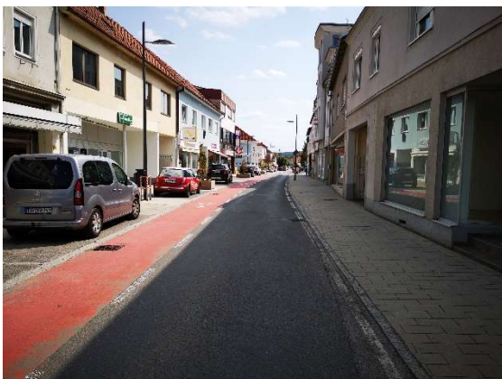
Farblich markiertes Radfahren gegen die Einbahn in der Hauptstraße südlich der Cafegasse
