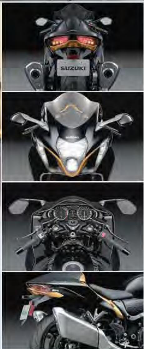
En cuanto al equipamiento el cuadro de instrumentos combina una pantalla TFT central con un velocímetro y un tacómetro analógicos; por su parte, la iluminación es de LED, manteniendo las formas reconocibles de las versiones anteriores de la Hayabusa. (Fotos: archivo Autonews)
