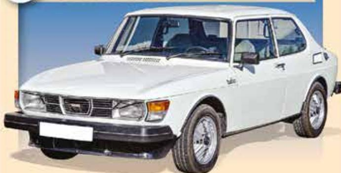
El sueco que trajo el turbo a la clase media. En lugar de invertir en la costosa producción de un modelo superior de seis cilindros, la marca vitaminó su 99 con un turbocompresor. En 1977, el automóvil más deportivo de Trollhättan fue el Saab Turbo, con llantas de aleación, suspensión más baja, un alerón y un indicador de presión de sobrealimentación en el tablero.
