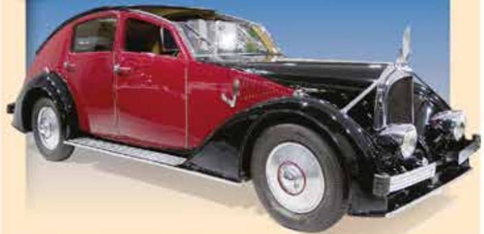
Era diferente por convicción. El ex fabricante de aviones Voisin fabricaba automóviles para excéntricos de la élite parisina. Su obra maestra, el Aérodyne, rueda con un chasis casi adaptativo, cuya firmeza puede ser ajustada por el conductor. Su techo corredizo, que simulaba las ventanas de un avión, contaba con accionamiento neumático, que era impulsado por la presión del colector de admisión.
