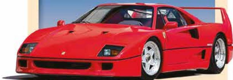
La venganza brutal de Ferrari: el viejo Enzo sabía que su reloj estaba corriendo, y el F40 debería ser su legado: motor V8 biturbo, 478 CV, 324 km/h de velocidad máxima. Técnicamente es un automóvil muy radical, ya que no dispone de ABS ni servofreno, además de que no existe sincronización en las marchas, ni dirección asistida ni ningún otro tipo de ayuda electrónica.
