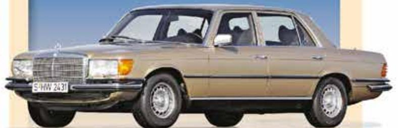
El destacado de los Autobahn se llama W 116 y lleva el motor más grande de los años 70, un Mercedes-Benz para jefes corporativos. La suspensión hidroneumática, la larga distancia entre ejes y el aire acondicionado venían de serie. Fue el Clase S más potente de la época, con un motor de enorme cilindrada. Se granjeó muchos fans, pero no tuvo sucesor.
