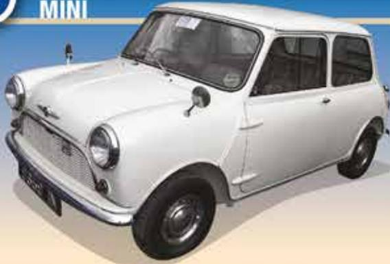
Todo el mundo lo amaba: desde los ases de los rallies hasta las familias con urbanas. El diseñador jefe de British Motor Company, Sir Alec Issigonis, inventó el mini automóvil moderno de tres metros en el que cabían cuatro adultos gracias al motor transversal y la tracción delantera. Mini destacaba sobre todo por su fácil conducción y su gran estabilidad: era un auto chico, rápido y de mucha calidad.
