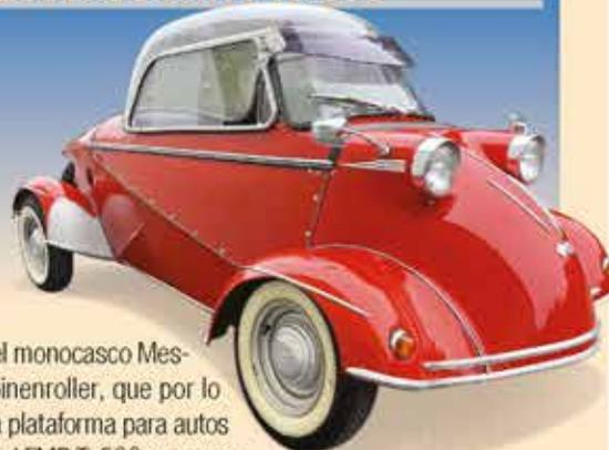
Basado en el monocasco Messerschmitt Kabinenroller, que por lo demás era una plataforma para autos de tres ruedas, el FMR Tg500 era un automóvil de cuatro ruedas con un motor dos tiempos, dos cilindros en línea y 500cc. Con 19 CV alcanzaba los 125 km/h con una aceleración de 0 a 100 en 25 segundos y pesaba apenas 360 kilos. Solo se fabricaron 290 unidades.
