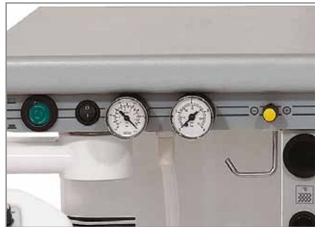
Manomètre et Vacuumètre (dans l'avant de l'unité).
