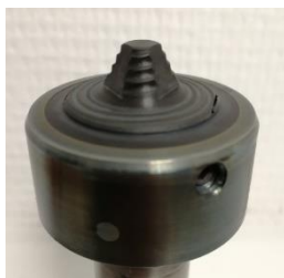
Outil FSW utilisé dans l'étude
