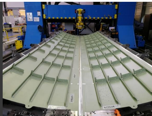
Exemples de soudage FSW de raidisseurs sur peau. Documents IS.
