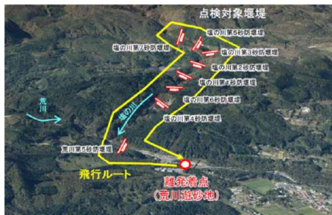
図1：今回行われた実証実験における点検対象の砂防ダム（砂防堰堤）と飛行ルート概要
