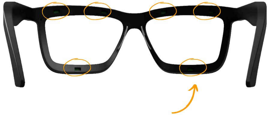
Notre monture est munie de capteurs infrarouges qui nous permettent de cartographier les yeux de la personne afin de **détecter n'importe quel mouvement autour ou dans les yeux.**
