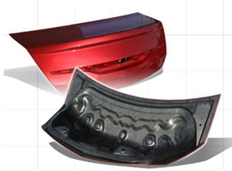
Porte de coffre Simulation d'injection (Continental Structural Plastics)
