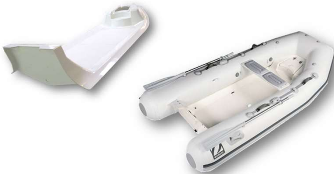
Coque de bateau semi-rigide Etude complète + prototype (Zodiac)
