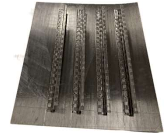
Soudage de lisses en Z en matériaux PA11-CF
