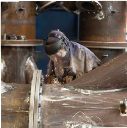
Vuylsteke monteert de J-Tubes in zijn werkplaats in Heule.
