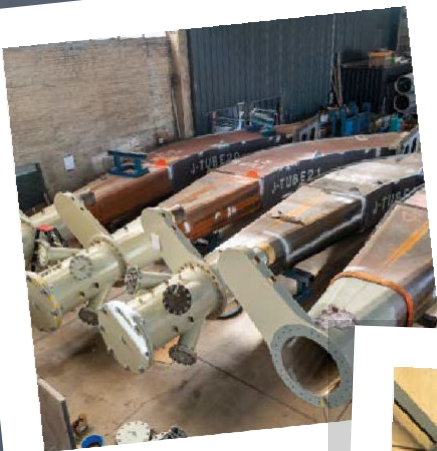
Vuylsteke produceert 88 J-Tubes, enorme stalen kabeldoorvoeren.
