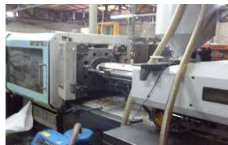
Inyectora 168 ton. Inyecta 250g.
