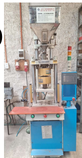
Inyect. Vertical 200 ton. Inyecta 400g.
