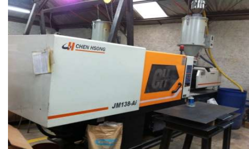
2 Inyectora 138 ton. Inyecta 180g.
