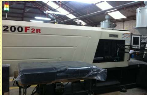
Inyectora 200 ton. Inyecta 400g.
