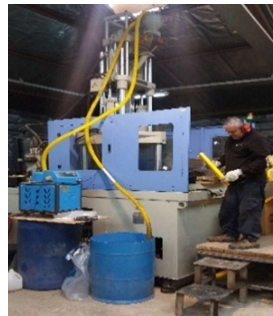
Inyect. Vertical 200 ton. Inyecta 400g.
