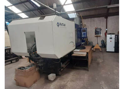
Inyectora 280 ton. Inyecta 700g.
