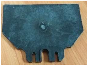
Prisma. Uso en embotelladora para tomar botellas por el cuello
