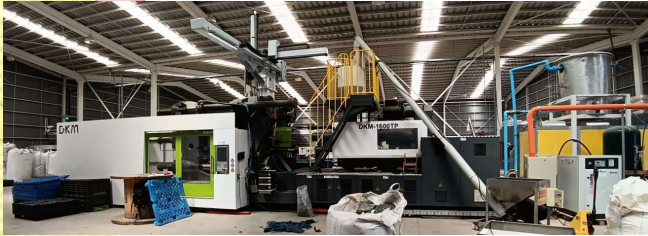
Inyectora 1600 ton. Inyecta 8Kg. Pallet.
