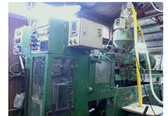
2 Inyectora 138 ton. Inyecta 180g.
