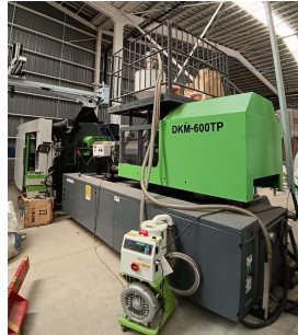
Inyectora 600 ton. Inyecta 2,5Kg.
