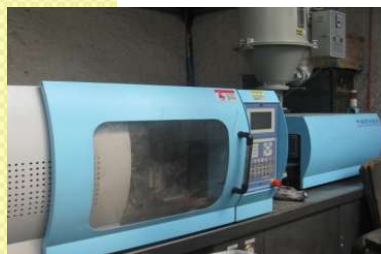
2 Inyectora 130 ton. Inyecta 180g.
