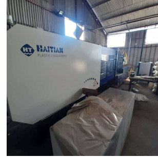
Inyectora 380 ton. Inyecta 1,1 Kg.
