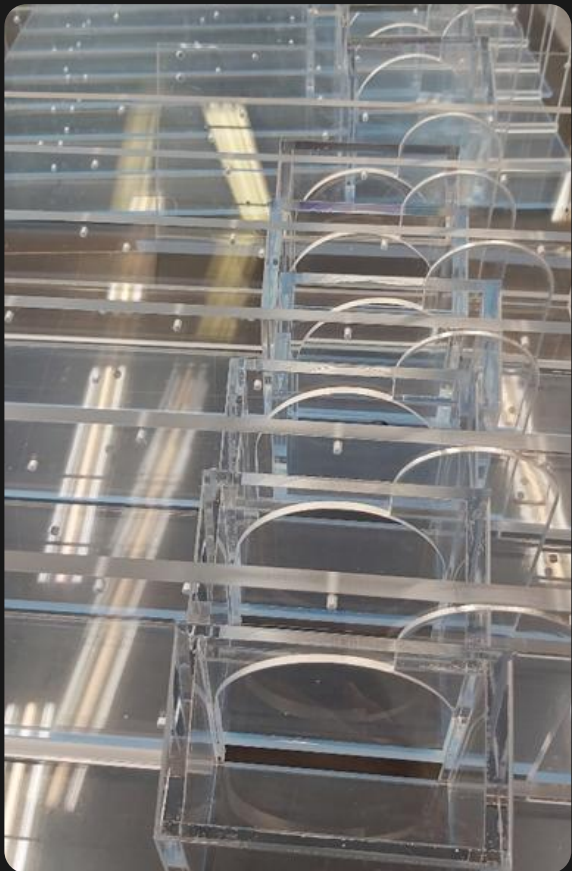
PMMA XT – mart, ragasztott gépelem
