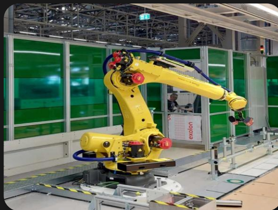
PC (Exolon) – NC vágott, laminált burkolat AUDI Magyarország, Q3 gyártósor
