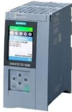
Si besoin, installation d'un automate SIEMENS SIMATIC 1500 S7 sert au pilotage des différents actionneurs autre que le cobot. Un écran SIMATIC TP1500 sert d'interface interactive avec l'opérateur. Il guide celui-ci dans l'ensemble de ces tâches (Changement de format, test, alarme, etc...). Cette interface est intuitive avec un design moderne et agrémenté de photos illustrant chaque demande à l'opérateur (gestions des formats, Etats de la machine, etc...).
