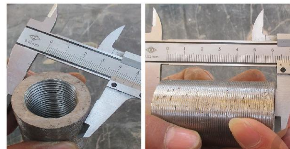
(5)、检查 \Phi 28 套筒外观尺寸，工艺标准为接头长度 65( 允许偏差 +2mm)、接头外径为 41( 允许偏差为 \pm 0.5 mm)，实际接头长度为 :65mm、接头外径为 41.1mm
