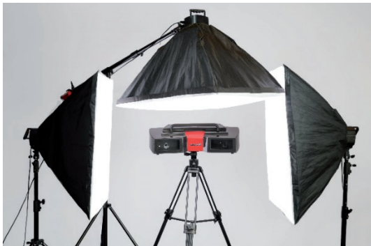
Système d'éclairage shadowless piloté pour un rendu de texture le fidèle possible
