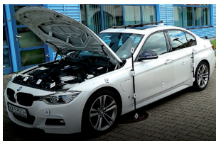
Placer les codes aruco et les marqueurs sur l'objet à scanner
