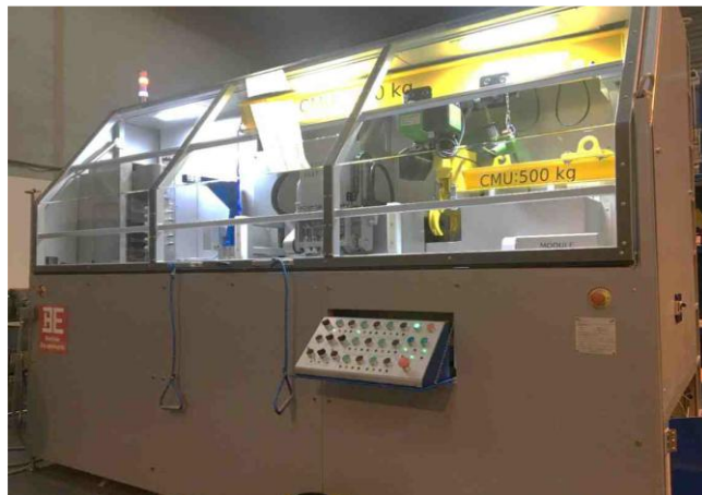
Machine à nettoyer les goujons de cuve des centrales nucléaires, et son chariot de manutention. Caractéristiques des goujons : 450 kg et 2,5 m de long.
