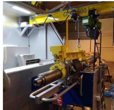
Machine à nettoyer les goujons de cuve des centrales nucléaires, et son chariot de manutention. Caractéristiques des goujons : 450 kg et 2,5 m de long.
