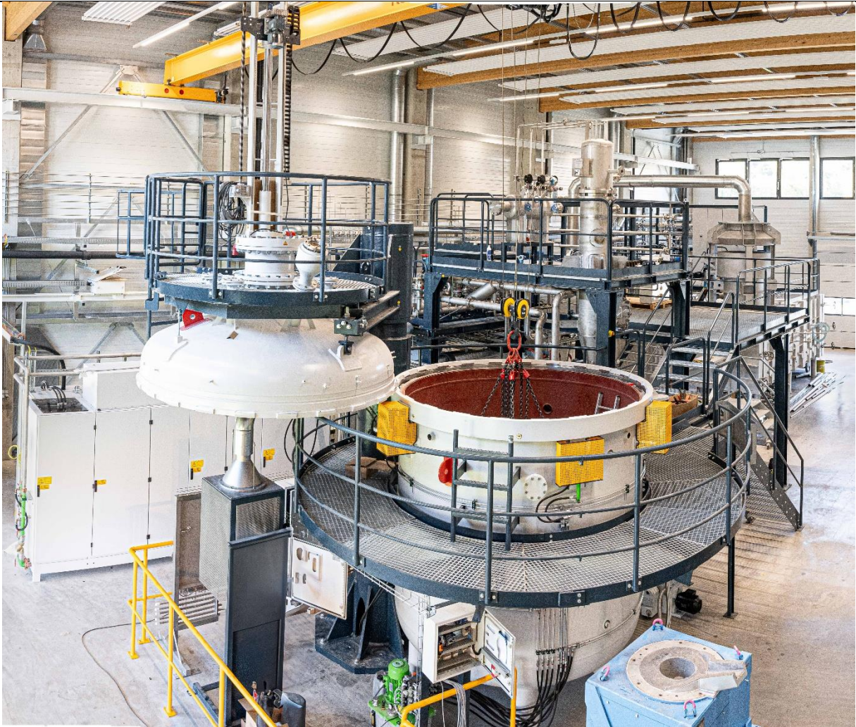
Abbildung 1: Demonstrationsanlage für die Methanpyrolyse in Metallschmelzen
