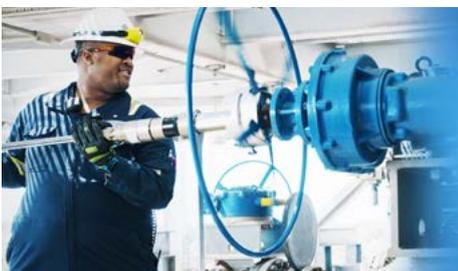
Utilisation d'un actionneur portable pneumatique (HL83) pour un volant nécessitant un grand nombre de tours dans une zone ATEX
