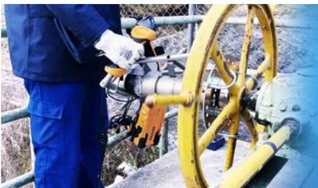
Utilisation d'un actionneur portable sur batterie (JA73) pour manœuvrer une vanne difficile
