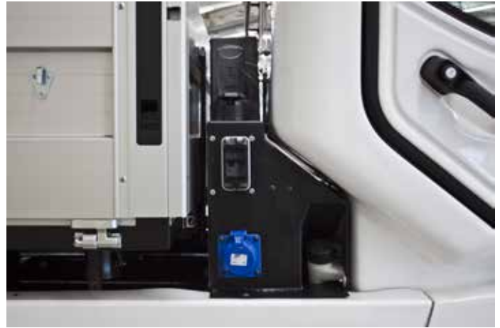
230V / 3000W IP65 Anschluss in der Zentralhydraulikbox integriert.
