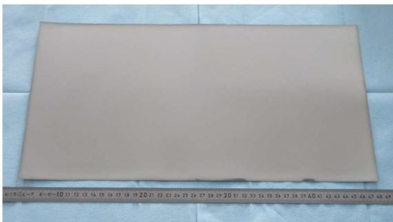
**Bild 2:** Freistehende Ni/Al-RMS-Folie, 430 x 220 mm<sup>2</sup>
