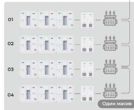
3*Масив (Загальна потужність: 60MWh)
