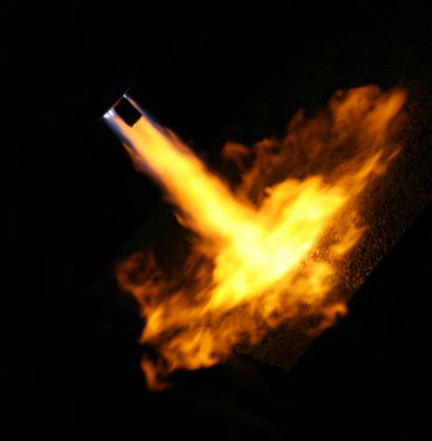
Les procédés de « projection thermique » désignent une famille de procédés par lesquels des **matières solides sont décomposées en fines particules à l'état liquide ou plastique dans un flux gazeux** pour former un revêtement sur un substrat.
