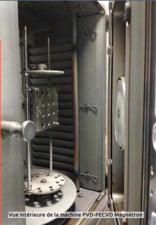
Vue intérieure de la machine PVD-PECVD Magnétron
