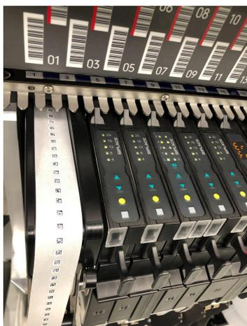
permite el control de fuerza de colocación, detección de pérdida de componentes, y detección de deformación (coplanaridad), todo ello en tiempo real.
