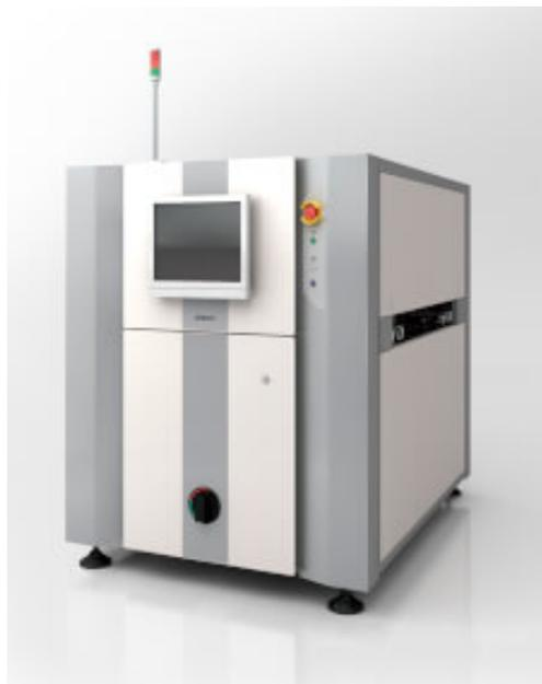
Esta máquina se encuentra al final de la línea y está sincronizada con el descargador de salida para descargarlas en GOOD o NO GOOD según el resultado de la inspección realizada.
