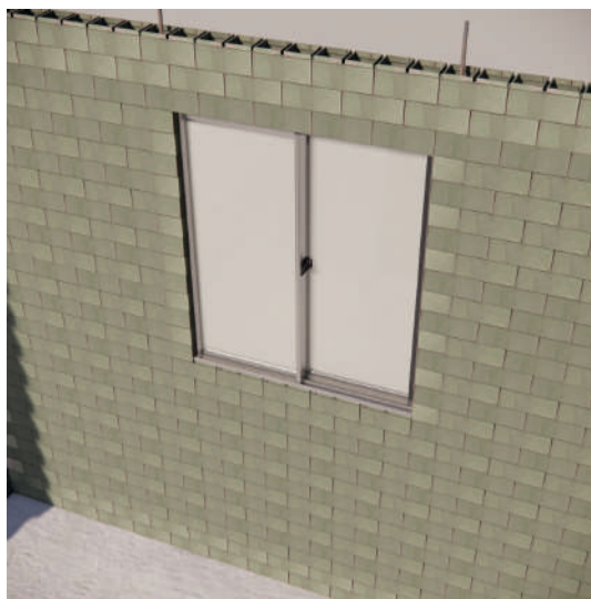
Paso 3. Vano de ventana.
