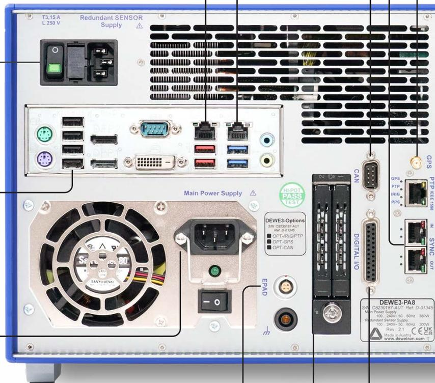
Hier sehen Sie eine beliebige Konfiguration eines typischen Advanced Power Analyzers: den DEWE3-PA8.
