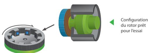
La contrainte mécanique est appliquée aux éprouvettes par la rotation. Le détachement du plot (moment du défaut) est détecté automatiquement.
