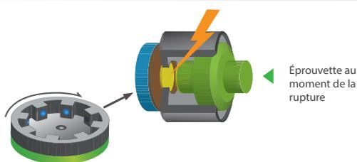
Une transmission codée IR indique la vitesse de rotation et la position de l'échantillon. La force à rupture et la contrainte max sont donnés par le logiciel SEPView®.
