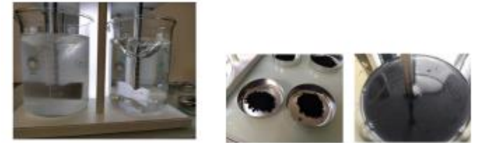
Figure 10. Photos des essais d'adsorption sur charbon actif réalisés en laboratoire
