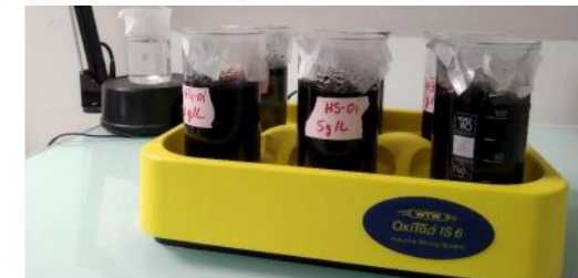
Figure 7. Réalisation des isothermes d'adsorption sur CA en laboratoire.
