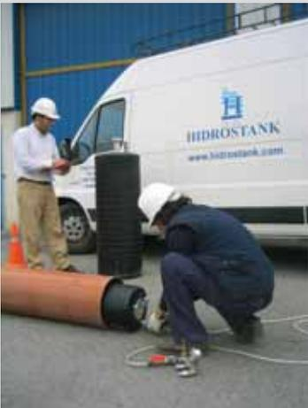
Cámara de inspección, compuesta de robot tractor y cámara oscilatoria, para acceder visualmente al interior de las conducciones, permitiendo la comprobación del estado real de la instalación (juntas, acometidas, pozos). Permiten monitorizar y registrar otros parámetros indicadores del estado y calidad de la instalación: pendientes, deformaciones del tubo...
