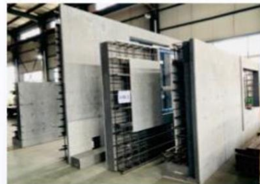
组装完成的免拆模板
