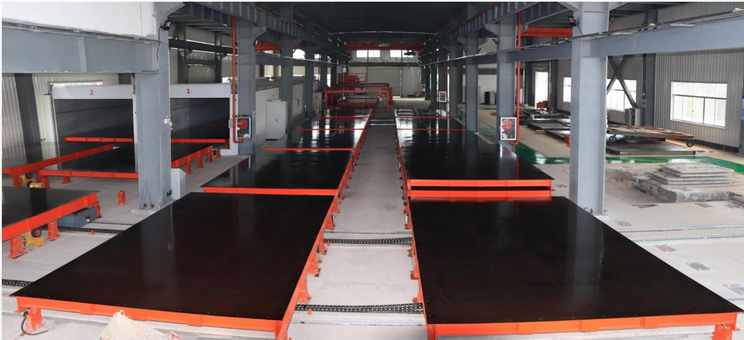
石墨烯装配式混凝土结构预制构件生产线
