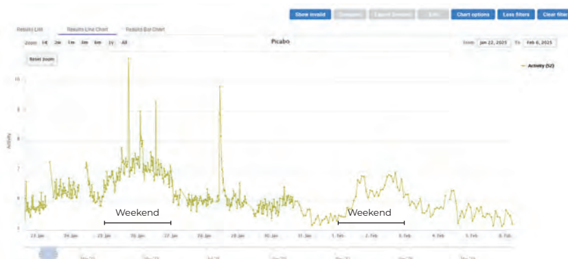
Zeitlicher Verlauf der Messungen des ColiMinder zur Überwachung einer in der Lebensmittelproduktion eingesetzten Umkehrosmoseanlage
