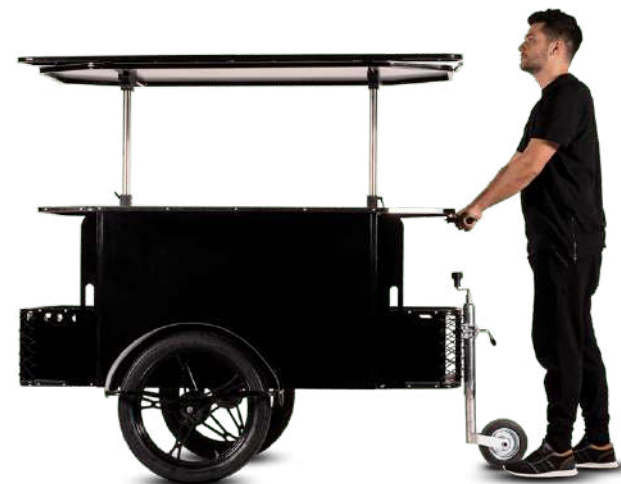
Gastro kolica su izvedena u dva oblika, kao kolica za guranje ili prikolica spojena s električnim biciklom što ih čini dodatno mobilnim.
