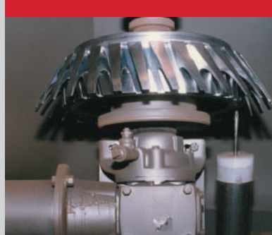
Fig. 4-8 Lance Peening of Fan Disk
