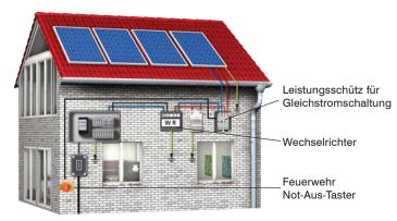
In vielen Photovoltaik-Anlagen befindet sich der in der Norm IEC 60364-7-712 geforderte Lasttrennschalter im Wechselrichter. Dadurch stehen auch nach Freischaltung die Leitungen zwischen Solarmodulen und Wechselrichter unter Spannung.
