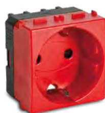
31176R Presa Schuko 2P+T 16A, terra laterale, Rossa
