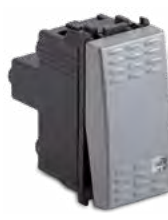
33013 ✨ Deviatore di linea 1P illuminabile 16AX 250V~, Steel
