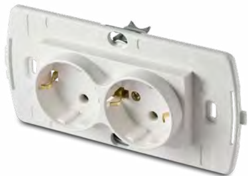
21176.2 Doppia presa Schuko 2P+T 16A con terra laterale 16A, con graffe per installazione su scatola tonda. Da completare con placca 4 moduli.
