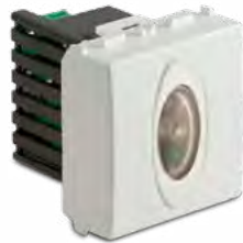
36465.2 Lampada d'emergenza 2 moduli, autonomia 120', luminosità 16cd, alimentazione 230V~, bianco
