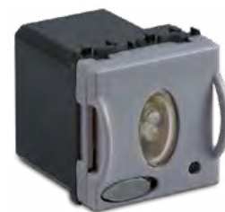
33462 Lampada d'emergenza estraibile 2 moduli, autonomia 120', luminosità 16cd, alimentazione 230V con interruttore, Steel
