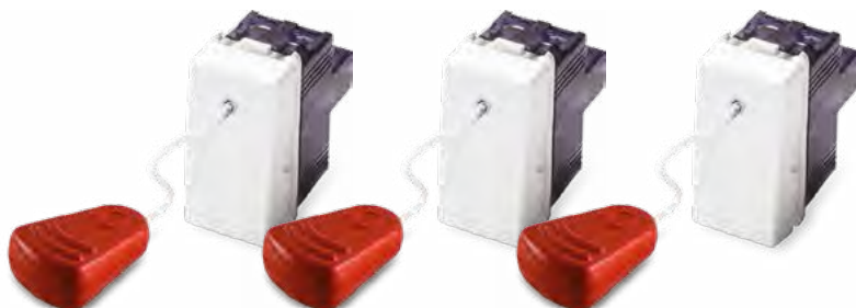
21030 ✨ Pulsante a tirante 1P NA 16A 250V~ completo di corda 2,25m
