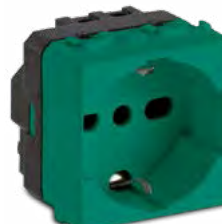
31170V Presa P40 "universale" 2P+T 16A 250V~ orizzontale, Verde
