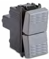
33022 Pulsante doppio 1P/NA+1P/NA+1P/ NC+1P/NC 16A 250V~, Steel
