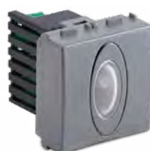
33466.2 Segnalatore d'emergenza 2 moduli, autonomia 12h, luminosità 3cd, alimentazione 230V~, Steel
