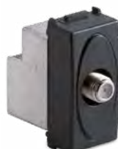
31274-DC Pres a coassiale F Femmina diretta con passaggio di corrente 5-2400Mhz, grigio
