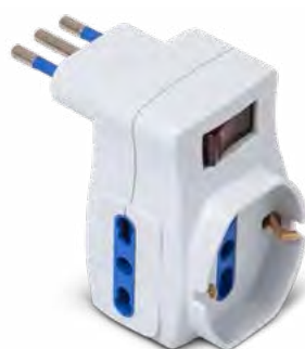
05692 Adattatore 2P+T con spina italiana S11 10A, 2 prese P17/11 "bivalenti" 16A e 1 presa P40 "universale" 2P+T 16A, interruttore automatico di sicurezza 10A secondo norma CEI EN 60898-1, Bianco.
