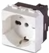
21170 Presa P40 "universale" a ricettività multipla 2P+T 16A 250V~
