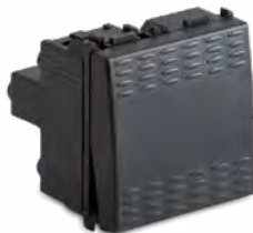
31003.2 Deviatore di linea 1P 2 moduli 16AX 250V~, grigio
