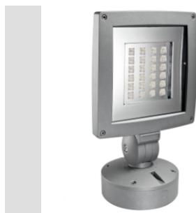
Proector din aluminiu turnat, vopsit cu pulbere de poliester după pasivare trivalentă. Rotație optică dublă datorită dozei centrale prevăzute cu scală goniometrică gradată pentru o indicare corectă. Sticla călită plată, grosime 4mm. Garnitură din silicon anti-îmbătrâniere. Bază de componente integrată pentru aplicații arhitectonice. Driver electronic de curent constant. Versiune de tehnologie cu LED monocromatic.
