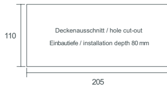
Deckenausschnitt KI Einbau / hole cut-out KI recessed
