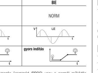
Az 1 jelű DIP kapcsolóval a programozás üzemmód (PROG) vagy a normál üzemmód (NORM) kiválasztásra szolgál. A 2 és 3 jelű DIP kapcsolók csak az 1 jelű DIP kapcsoló ki állapotban engedélyezhetők.
