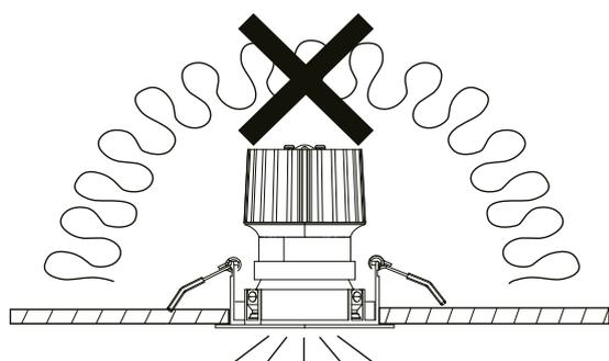
Attenzione! Apparecchio non idoneo ad essere ricoperto di materiale termicamente isolante.
