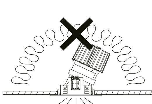
Attenzione! Apparecchio non idoneo ad essere ricoperto di materiale termicamente isolante.
