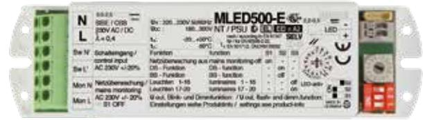
Das MLED500-E ist ein elektronisches Schaltnetzteil mit integrierter Einzelleuchtenüberwachung, Leuchtenmanagerfunktion Netzüberwachung, Dimm- sowie Blinkfunktion. Es versorgt LED-Leuchtmittel bis zu einer Leistung von 8 Watt. Das MLED500-E ist geeignet für den Einsatz an Stromversorgungssystemen vom Typ: **multiControl plus, midiControl plus, miniControl plus, microControl plus, sowie myControl plus.**
