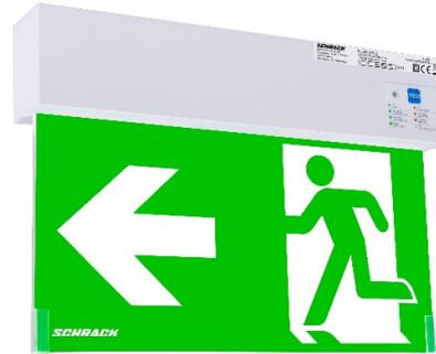
Rettungszeichen- Einzelbatterieleuchte gemäß EN 60598-1, EN 60598-2-22, ISO 7010 und EN 1838 für Wand- oder Deckenmontage mit ein- oder zweiseitiger Beschriftung. Geeignet für Dauer- oder Bereitschaftsschaltung. Piktogrammset (links, rechts, oben, unten, neutral) standardmäßig im Lieferumfang enthalten. Über einen potentialfreien Kontakt an den Klemmen f+/f- kann die Notlichtfunktion blockiert werden.
