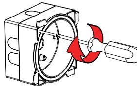
Schrauben Sie das IP65 Gehäuse auf den Adapter.
