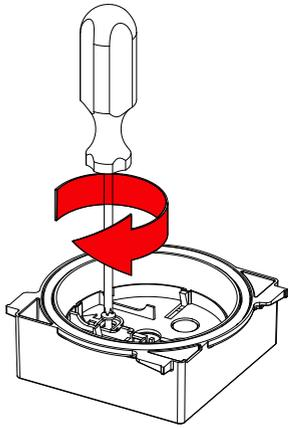
Bodenplatte der IL-Leuchte anschrauben.
