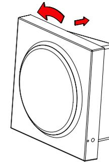
Setzen Sie den Deckel des IP65 Gehäuses auf und drehen es nach links.
