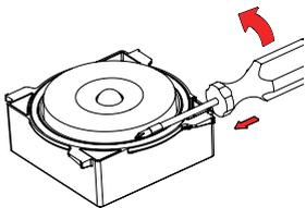
Schieben Sie einen Schraubendreher durch die Schlaufe und hebeln sie nach oben.
