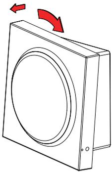
Drehen Sie den Deckel nach rechts und lösen ihn vom Gehäuse.
