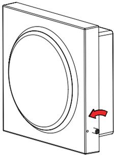
Lösen Sie die Schrauben am Gehäuse.
