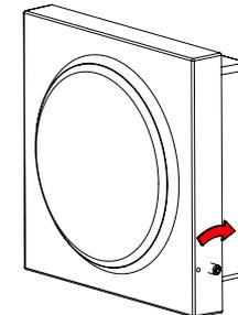
Verschrauben Sie das Gehäuse mit beiden Schrauben gleichmäßig bis zum Anschlag.
