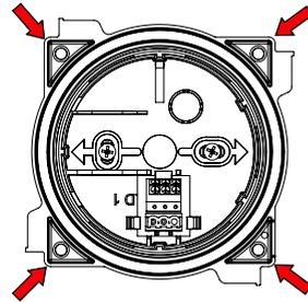
Zeichnen Sie die Befestigungslöcher an und bohren sie.
