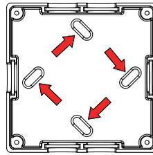
Zeichnen Sie die Befestigungslöcher an, bohren Sie und verschrauben den Adapter an der Wand/Decke.
