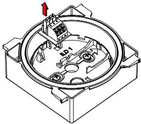
Entfernen Sie die Platine aus der IL-Leuchte.
