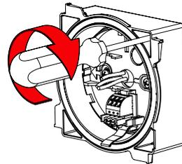
Schrauben Sie das Gehäuse an der Wand/Decke an. (Schrauben nicht im Lieferumfang enthalten)
